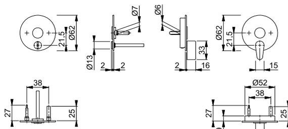
Die Griffrosette kann optional mit einer Rückholfeder ausgestattet werden: Rückholfederpaket Z-RFL18 siehe S. 384, entsprechende Bohrschablone für die Türvorbereitung siehe S. 384.
