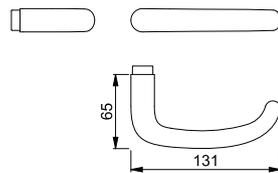
Geeignet für Feuerschutztüren nach **EI30** und Notausgangsverschlüsse nach **DIN EN 179**.
