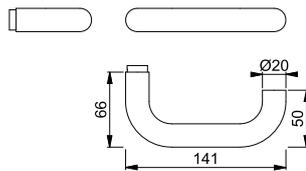
Geeignet für Notausgangs-Verschlüsse nach **DIN EN 179**.
