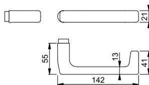
Geeignet für Feuerschutztüren nach **EI30** und Notausgangsverschlüsse nach **DIN EN 179**.
