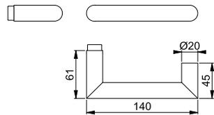
Geeignet für Feuerschutztüren nach **EI30** und Notausgangsverschlüsse nach **DIN EN 179**.
