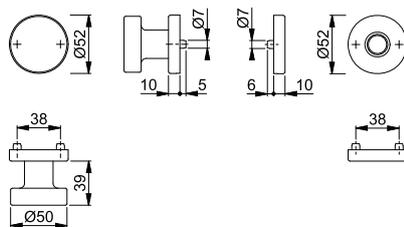
Geeignet für Notausgangs-Verschlüsse nach **DIN EN 179**.
