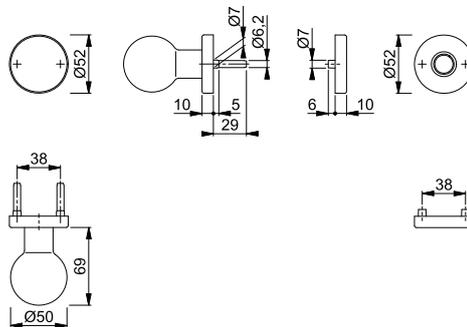
Geeignet für Feuerschutztüren nach **EI30** und Notausgangs-Verschlüsse nach **DIN EN 179**.
