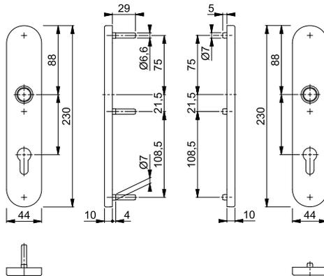
Geeignet für Feuerschutztüren nach **EI30** und Notausgangsverschlüsse nach **DIN EN 179**.
