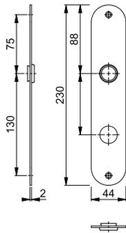
Das Flach-Langschild kann optional mit einer Rückholfeder ausgestattet werden: Rückholfederpaket Z-RFL18 siehe S. 384.
