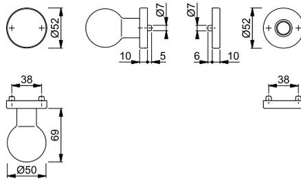
Geeignet für Notausgangs-Verschlüsse nach **DIN EN 179**.
