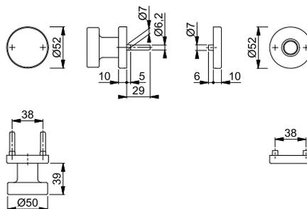
Geeignet für Feuerschutztüren nach **EI30** und Notausgangs-Verschlüsse nach **DIN EN 179**.
