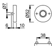
Geeignet für Notausgangs-Verschlüsse nach **DIN EN 179**.
