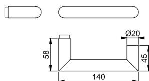
Geeignet für Notausgangs-Verschlüsse nach **DIN EN 179**.
