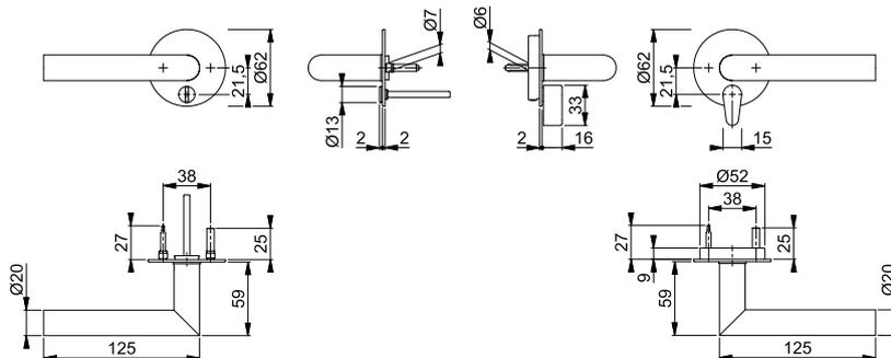
Die Griffrosette kann optional mit einer Rückholfeder ausgestattet werden: Rückholfederpaket Z-RFL18 siehe S. 384, entsprechende Bohrschablone für die Türvorbereitung siehe S. 384.
