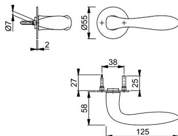
Die Griffrossette kann optional mit einer Rückholfeder ausgestattet werden: Rückholfederpaket Z-RFL18 siehe S. 384, entsprechende Bohrschablone für die Türvorbereitung siehe S. 384.
