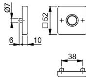
Geeignet für Notausgangs-Verschlüsse nach **DIN EN 179**.
