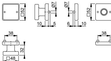
Geeignet für Notausgangs-Verschlüsse nach **DIN EN 179**.
