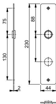
Das Flach-Langschild kann optional mit einer Rückholfeder ausgestattet werden:
