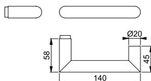
Geeignet für Notausgangs-Verschlüsse nach **DIN EN 179**.
