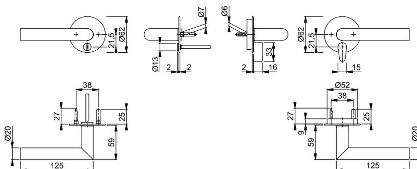
Die Griffrosette kann optional mit einer Rückholfeder ausgestattet werden: Rückholfederpaket Z-RFL18 siehe S. 343, entsprechende Bohrschablone für die Türvorbereitung siehe S. 342.
