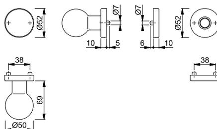
Geeignet für Notausgangs-Verschlüsse nach **DIN EN 179**.
