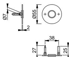
Die Griffrosette kann optional mit einer Rückholfeder ausgestattet werden: Rückholfederpaket Z-RFL18 siehe S. 343, entsprechende Bohrschablone für die Türvorbereitung siehe S. 342.
