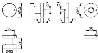
Geeignet für Notausgangs-Verschlüsse nach **DIN EN 179**.
