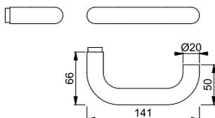
Geeignet für Notausgangs-Verschlüsse nach **DIN EN 179**.
