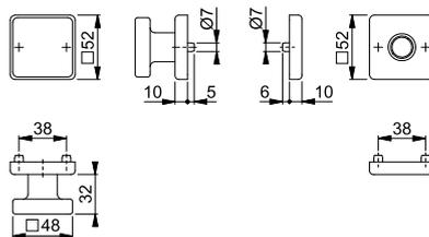
Geeignet für Notausgangs-Verschlüsse nach **DIN EN 179**.
