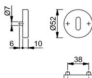
Geeignet für Notausgangs-Verschlüsse nach **DIN EN 179**.
