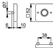
Geeignet für Notausgangs-Verschlüsse nach **DIN EN 179**.
