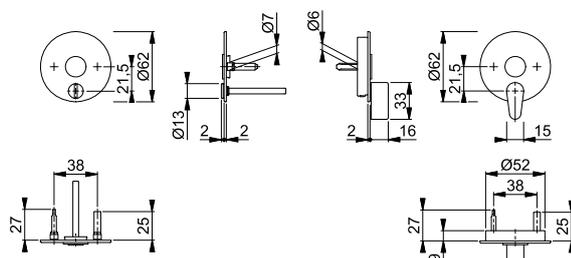
Die Griffrosette kann optional mit einer Rückholfeder ausgestattet werden: Rückholfederpaket Z-RFL18 siehe S. 343, entsprechende Bohrschablone für die Türvorbereitung siehe S. 342.
